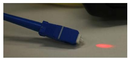
Figure 1.1.4-1 Visual Fault Locator (VFL)
