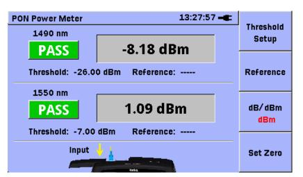
Figure 1.1.5-1 PON Power Meter Screen
